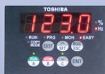
Fernbedienung mit 20 mm hoher LED-Anzeige und Funktionstasten
