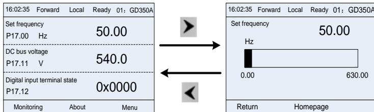
Abbildung 5.4 Anzeige eines Parameters im gestoppten Zustand
