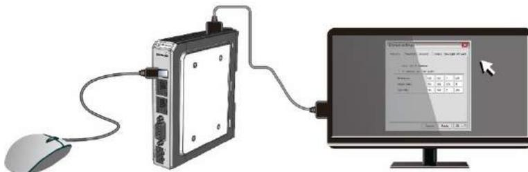
Nachdem das cMT-FHDX-220 hochgefahren und am Monitor/TV ein Bild zu sehen, drücken Sie den Startschalter in der oberen linken Ecke, um das Dialogfeld „System Settings“ zu öffnen. (Standard-Systemkennwort: 111111)
