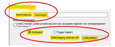
Die Einstellungen bedeutet, dass jede Sekunde die konfigurierten Daten gespeichert werden.
