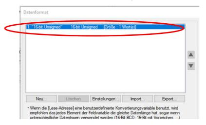
Wiederholen Sie den Vorgang. Da zuvor der Schalter "Als Standard speichern" betätigt wurde, öffnet sich das Konfigurationsfenster automatisch mit dem Eintrag "16-bit Unsigned". Soweit keine anderen Einstellungen für dieses Datenwort notwendig sind, können Sie die Auswahl einfach mit OK bestätigen.
