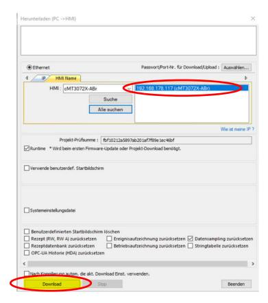
Starten Sie den Download des Projekts zum Panel mit dem Schalter [Download]. Während des Downloads wird im oberen Anzeigebereich der Fortschritt angezeigt. Mit "Fertiggestellt" wird verdeutlicht, dass das Herunterladen abgeschlossen ist.
