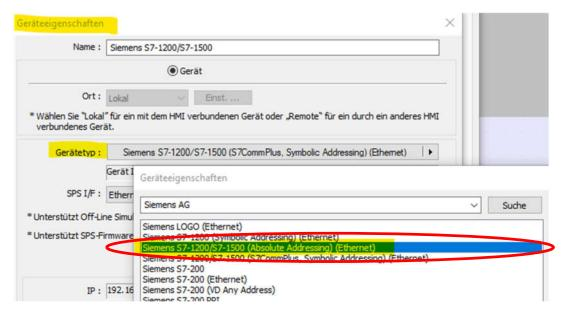
Drücken Sie auf die Schalfläche neben "Gerätetyp" und markieren Sie den Eintrag "Siemens S7-1200/S7-1500 (Absolute Addressing) (Ethernet)" und bestätigen die Auswahl mit OK.
