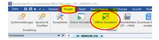
Daraufhin wird das Projekt von EasyBuilder Pro kompiliert und es wird der cMTViewer mit dem Projekt gestartet. Im cMTViewer wird die Startseite des neu erstellten Projekts dargestellt. Der cMTViewer kann mit der Maus bedient werden. Mit dem Schalter SCHALTER LAMPEN können Sie die gleichnamige Bildschirmseite öffnen.
