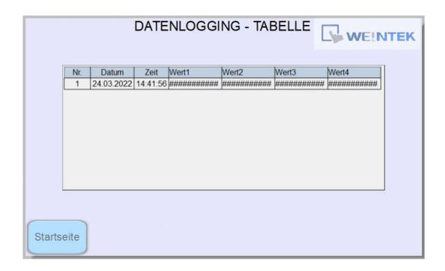
Damit beim Datenlogging auch verschiedene Werte sichtbar werden, platzieren wir neben der Verlaufsdatenanzeige vier numerische Anzeigen mit den Adressen DB1.DBW200 bis DB1.DBW206. Bei allen Anzeigen soll die Funktion "Eingabe erlauben" aktiviert sein.
