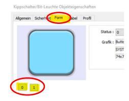
Hierdurch kann das Aussehen des Schalters für jeden Schaltzustand bearbeitet werden.
