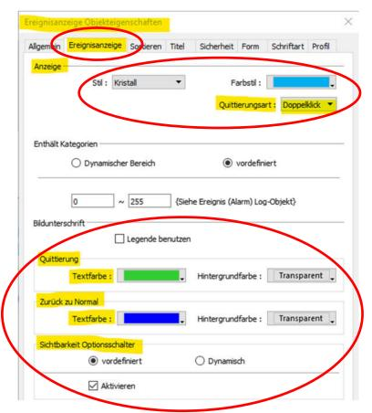
Bei "Quittierung" wird die Textfarbe angegeben, mit der die Meldung nach der Quittierung aber vor dem Rücksetzen des Alarmworts/-bits angezeigt wird.
