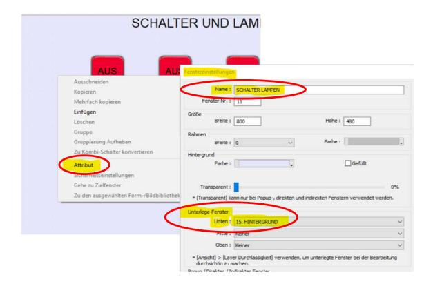
In den Fenstereinstellungen gibt es einen Bereich mit der Bezeichnung "Unterlege-Fenster". Bereits erstellte Fenster können anderen Fenstern "unterlegt" werden. Es stehen hierfür drei Layer/Ebenen zur Verfügung. Somit könnte man drei unterschiedliche Hintergrundfenster erstellen, die einer Bildschirmseite in drei Ebenen übereinander angeordnet werden.
