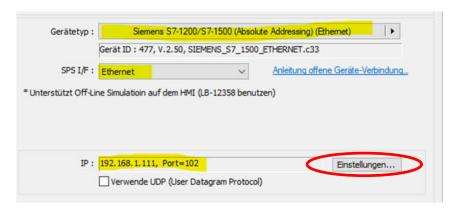
Legen Sie bei "IP" die IP-Adresse der mit dem HMI verbundenen SPS S7-1200 fest, indem Sie auf die Schaltfläche [Einstellungen…] drücken. Die Port-Nr. ist standardmäßig "102".
