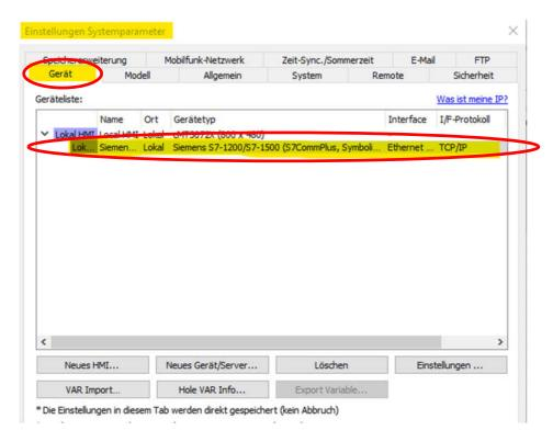
Im nächsten Schritt <u>muss</u> für dieses Kommunikationsprotokoll der Variablen-Import durchgeführt werden.
