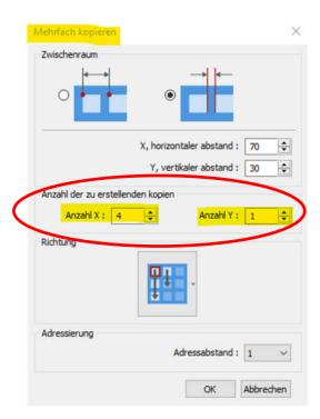
Mit Hilfe des Mehrfachkopierens können auch die Adressen der neuen Schalter automatisch angepasst werden. Voraussetzung hierfür ist die Verwendung von absoluten Adressen.
