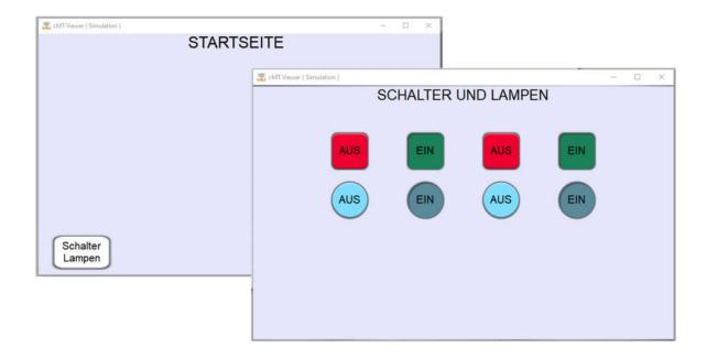
Durch Drücken auf den/die Schalter wird automatisch die Änderung der Lampe/Bit-Leuchte sichtbar. Auf diesem Weg kann man prüfen, ob im Projekt bspw. die Adresszuweisung korrekt durchgeführt wurde.
