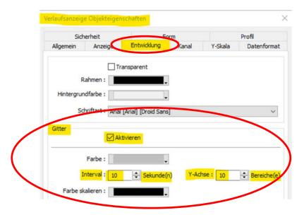
Im nächsten Abschnitt dieser Registerkarte kann eine Zeitskalierung entlang der X-Achse festgelegt werden. In diesem Beispiel wird lediglich die Zeit einschließlich Sekunden unterhalb der X-Achse angezeigt.
