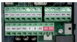
Mit bis zu acht digitalen und drei analogen, konfigurierbaren Eingängen ist der VF-S15 auch für komplexe Antriebssteuerungen gut gerüstet. Praktisch: Das Panel kann für externe Steueraufgaben über die serielle Schnittstelle unabhängig vom Umrichter genutzt werden.
